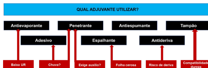
Figura 4. Fluxograma para seleção de alguns adjuvantes para mistura em tanque. Os retângulos na cor vermelha indicam a necessidade de cada aplicação, e aqueles em preto as características para atender a cada necessidade. Fonte: adaptado de Matthews (2017).
